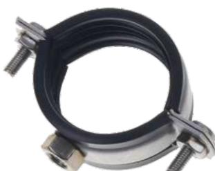
Эти хомуты предназначены для крепления труб, которые монтируются в агрессивных средах и в пищевом производстве. Крепление трубы комплектуется прокладками из резины (для снижения шума и вибраций). Под заказ могут быть укомплектованы резиновыми прокладками из силиконового или фторсиликонового каучука.
